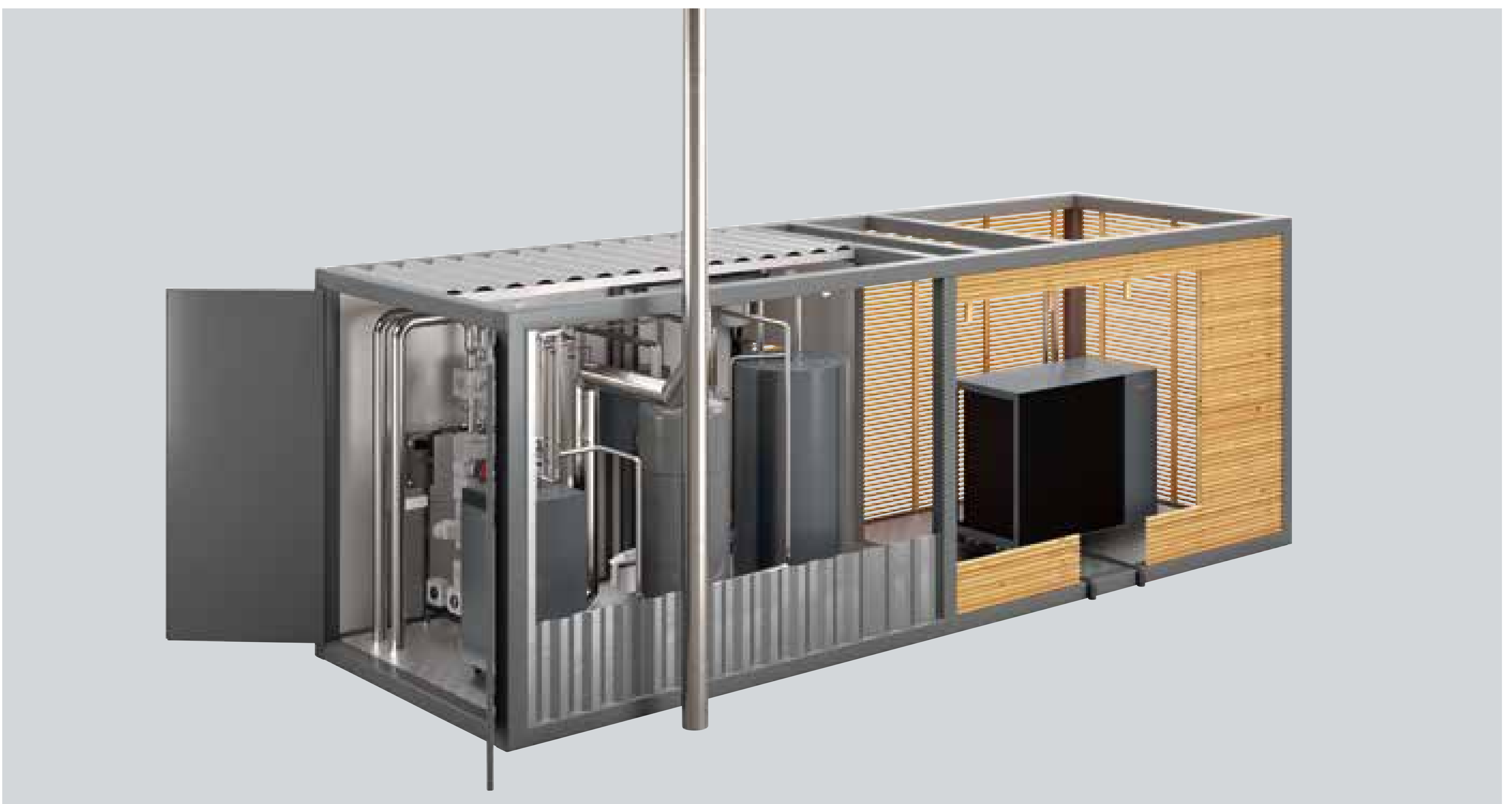
Container mit Luft/Wasser-Wärmepumpe Vitocal 250-A PRO, Gas-Brennwertkessel Vitocrossal 300 (Typ Cl3) und Heizwasser-Pufferspeicher Vitocell 050-E EC-PRO
